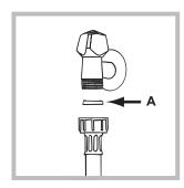
1. Inserire la guarnizione A nell'estremità del tubo di alimentazione e avvitarlo a un rubinetto d'acqua fredda con bocca filettata da 3/4 gas (vedi figura).
