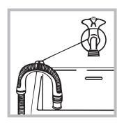
In alternativa, appoggiare il tubo di scarico al bordo di un lavandino o di una vasca, legando la guida (acquistabile presso il servizio assistenza) al rubinetto (vedi figura). L'estremità libera del tubo di
