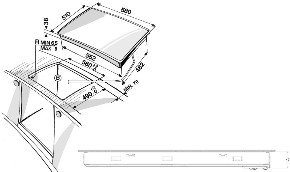
Tipo PLEATC 220-240 V ~ /380-415 V 3 N ~ 50/60 Hz 6,2 kW
