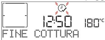
Premere + o - per impostare l'ora di fine cottura desiderata, quindi premere ✓ per confermare e attivare la funzione. Introdurre gli alimenti nel forno e chiudere lo sportello: la funzione si avvierà automaticamente dopo un periodo di tempo calcolato per terminare la cottura all'orario impostato.
