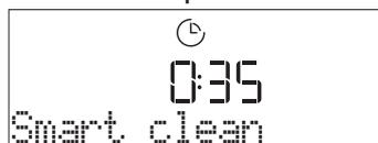
Premere  $\triangleright$  per attivare la funzione: il display indicherà le operazioni richieste per ottenere una pulizia ottimale: seguire le indicazioni e quindi premere  $\checkmark$ . Una volta eseguite tutte le operazioni
