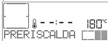
Al termine di questa fase, un segnale acustico e il display indicheranno che il forno ha raggiunto la temperatura impostata e comparirà la richiesta "AGG. ALIMENTO". A questo punto, aprire la porta, inserire gli alimenti nel forno, chiudere la porta e procedere alla cottura.
