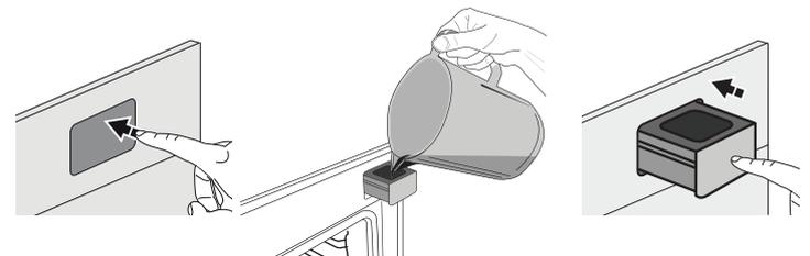
Sarà necessario aggiungere acqua solo se il livello del serbatoio non è sufficiente per completare la cottura. Si raccomanda di non riempire il serbatoio a forno spento o prima che compaia il messaggio corrispondente sul display.
