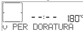
Quando il display mostra il messaggio corrispondente, premendo  $\checkmark$  viene avviato un ciclo di doratura di cinque minuti. Questa funzione può essere interrotta in qualsiasi momento premendo  $\text{OFF}$  per spegnere il forno.
