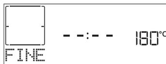
Premere  $\triangleright$  per continuare la cottura in modalità manuale (senza timer) o premere  $+$  per prolungare il tempo di cottura impostando una nuova durata. In entrambi i casi, i parametri di cottura saranno mantenuti. Dopo avere estratto le pietanze, lasciar raffreddare il forno con la porta chiusa.
