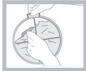
**El filtro es una parte esencial para el secado. Su misión es recoger la pelusa que se forma durante el proceso de secado. Si el filtro está obstruido, el flujo de aire dentro de la secadora puede verse gravemente afectado: esto aumentará el tiempo de secado y el consumo energético, y podría dañar la secadora.**
