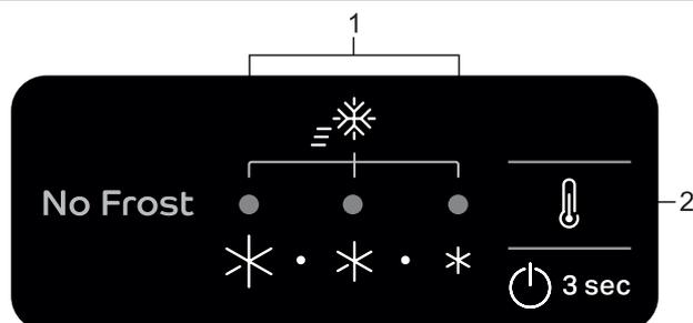
1. Светодиодные индикаторы (индикация текущей настройки температуры или функции «Суперзаморозка»)
