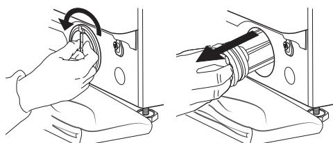
5. Puhdista vesisuodatin: poista jäätä suodattimesta ja puhdista se juoksevan veden alla.
