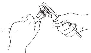
3. Skru nu indløbsslangen af bag på vaskemaskinen med hånden. Træk trådfilteret ud af ventilen bag på vaskemaskinen med en tang og rengør det forsigtigt.
