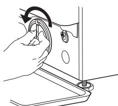
4. Ta ut filteret: Legg en bomullsklut under vannfilteret som kan absorbere mindre vannmengder. Drei vannfilteret mot klokken og ta det ut.
