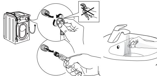
4. Sett nettfilteret inn igjen. Koble inntaksslangen til vannkranen og vaskemaskinen igjen. Bruk ikke et verktøy for å koble til inntaksslangen. Åpne vannkranen og sjekk at alle koblingene er tette.
