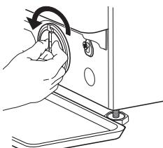
4. Poista suodatin: aseta puuvillakangas vesisuodattimen alle, jotta se voi imeä pienien määriin jäljelle jäänyttä vettä. Poista sitten vesisuodatin kääntämällä sitä vastapäivään.
