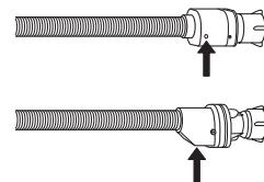
For vannstopp: sjekk sikkerhetsventilens lille inspeksjonsvindu (se pil). Hvis det er rødt, er vannstoppfunksjonen utløst, og slangen må skiftes ut med en ny.
