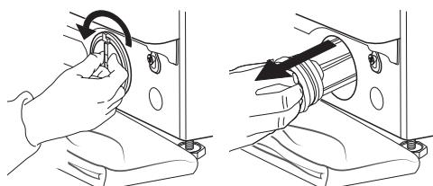
5. Rengjøre vannfilteret: Fjern rester og rengjør filteret under rennende vann.
