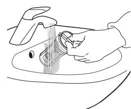
6. Sett inn vannfilteret og sokkeldekselet: Sett inn vannfilteret og drei det med klokken. Drei filteret så langt det går. Filterhåndtaket skal være i vertikal stilling. For å teste at vannfilteret er vanntett, kan du helle ca. 1 liter vann i vaskemiddelskullen. Sett sokkeldekselet på plass igjen.
