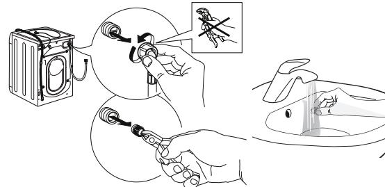
4. Sätt in nätfiltret igen. Anslut inloppsslangen till vattenkranen och tvättmaskinen igen. Använd inte ett verktyg för att ansluta inloppsslangen. Öppna vattenkranen och kontrollera att alla anslutningar är ordentligt åtdragna.
