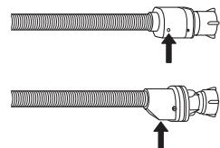
För vattenstoppslangar: kontrollera den lilla säkerhetsventilens inspekionsfönster (se pil). Om den är röd har vattenstoppfunktionen löst ut och slangen måste bytas ut mot en ny.
