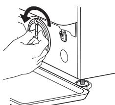
4. Ta bort filtret: lägg en bomullsduk under vattenfiltret, som kan absorbera en liten mängd resterande vatten. Ta sedan bort vattenfiltret genom att vrida det moturs.
