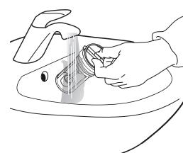
6. Sätt in vattenfiltret och sätt tillbaka sockeln: sätt tillbaka vattenfiltret igen genom att vrida det medurs. Vrid filtret så långt det går; filtrets handtag ska vara i vertikalt läge.
