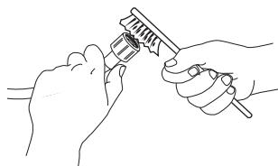
3. Løsne nå vanninntaksslangen på baksiden av vaskemaskinen for hånd. Bruk en tang og trekk ut nettfilteret fra ventilen på baksiden av vaskemaskinen og rengjør det nøyne.
