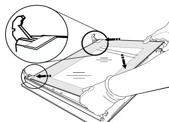
4. Sätt in den övre kanten: Ett klickljud anger att det är korrekt insatt. Försäkra dig om att tätningen är säker innan luckan monteras tillbaka.
