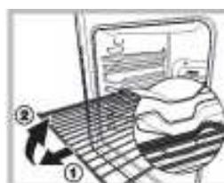
**VARNING!** Ugnen är utrustad med ett stoppsystem för att ta ut gallret och förhindra dem från att komma ut ur ugnen (1)
