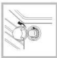
1. Etter at du har koblet ovnen fra hovedstrømforsyningen, fjern glasslokket som dekker pæresokkelen (se figur).
