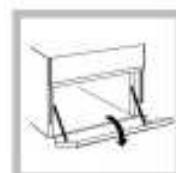
Det finns ett utrymme under ugnen som kan användas för att förvara ugnstillbehör och ugnformer. För att öppna luckan, dra den nedåt (se bild).
