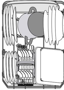
Para ollas, tapas, platos, ensaladeras, cubertería, etc. Se recomienda colocar las bandejas y tapas grandes en los laterales para evitar interferencias con el brazo aspersor.
