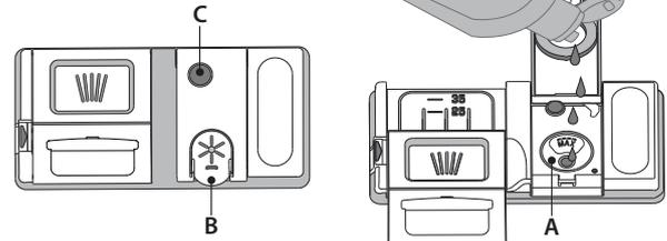
1. Abra el dispensador **B** pulsando y levantando la lengüeta de la tapa.
