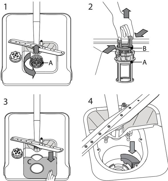
Una vez limpiados los filtros, recolóque el conjunto de filtrado y encájelo correctamente en su sitio; esto es esencial para garantizar el funcionamiento eficiente del lavavajillas.
