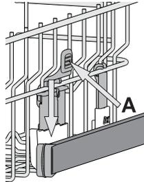
Para volver a la posición más baja, pulse las palancas **A** de los laterales de la bandeja y mueva el cesto hacia abajo.
