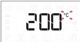
Wenn die Symbole °C/°F auf dem Display blinken, den Knopf drehen, um den Wert zu ändern, anschließend
