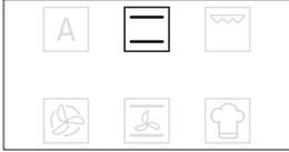
Zur Auswahl einer Unterfunktion (sofern verfügbar), die Hauptfunktion auswählen, anschließend
