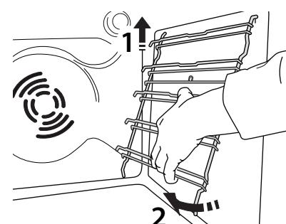
Přejete-li si boční vodicí mřížky opět nasadit, nejprve je nasadte do jejich usazení v horní části. Držte je zdvihnuté a zasuňte je do vnitřní části trouby a poté posuňte směrem dolů do polohy pro usazení v dolní části.
