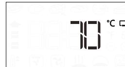
Stiskem spusťte nastavení. Otáčením ovladače nastavte cílovou teplotu sondy. Stiskem volbu potvrďte.
