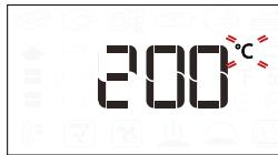
Amikor a kijelzőn villog a  $^{\circ}\text{C}/^{\circ}\text{F}$  ikon, a beállítógombbal megváltoztathatja az értékét, majd nyomja meg az gombot a jóváhagyáshoz és a további beállítások (ha vannak) módosításához.
