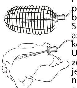
Pro dosažení perfektních výsledků pečení je velmi důležité, aby byl teplomér umístěn přesně. Sondu zasuňte do nejmasitější části až po okraj tak, abyste se vyhnuli kostem a tučným kouskům. U drůbeže by se měla sonda vkládat ze strany doprostřed prsou, přičemž je potřeba dbát na to, aby její špička neskončila v duté části. U masa s velmi nepravidelnou tloušťkou je potřeba před vyjmutím z trouby zkontolovat, zda je dostatečně propečené.
