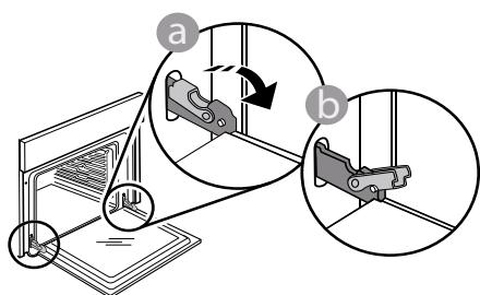
Снимите дверцу, одновременно закрывая и смещая ее вверх. Положите дверцу на мягкую поверхность.
