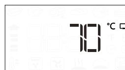
Stlačením spustite nastavenia. Otáčaním gombíka nastavte cielovú teplotu mäsovej sondy. Stlačením potvrdte. Otáčaním gombíka nastavte teplotu priestoru rúry.
