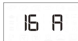
Otočením voliaceho gombíka vyberte menovitý prúd a potvrdte stlačením .
