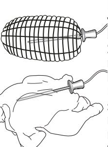
Precízne umiestnenie sondy je veľmi dôležité na dosiahnutie bezchybných výsledkov pečenia. Sondu zapichnite do časti, kde sa nachádza najviac mäsa. Vyhýbajte sa kostiam a častiam s tukom. Pri hydine sa sonda vkladá zboču do stredu prás, tak aby sa špička sondy nedostala do dutej časti. Ak má mäso rôznu hrúbku, pred vybratím z rúry skontrolujte, či sa upieklo rovnomerne. Koniec sondy pripojte do otvoru na pravej stene priestoru rúry.
