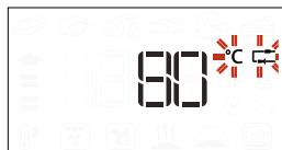
Нажмите или , чтобы подтвердить значение и начать процесс приготовления. В процессе приготовления на дисплее отображается итоговая температура термощупа. Когда температура мяса достигает заданного итогового значения, цикл приготовления останавливается и на дисплей выводится надпись "End" ("Конец").
