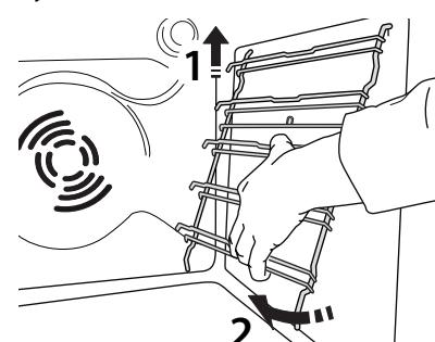
A polcvezető sínek visszaszereléséhez először a felső helyükre szerelje őket vissza. Felfelé tartva csúsztassa őket a sütőtérbé, majd engedje le őket az alsó illesztésben lévő helyzetükbe.
