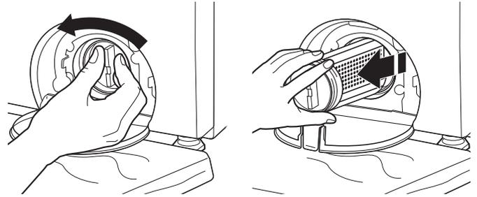
4. Remova pedaços grandes de sujidade manualmente do filtro e coloque a sujidade num caixote do lixo adequado.
