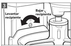
Ajuste para mantener la distancia entre el batidor plano y la superficie inferior del recipiente cuando esté en la posición elevada girando el tornillo hacia la izquierda para levantar el recipiente y hacia la derecha para bajarlo. Solo tendrá que girarlo un poco: el tornillo (A) no girará más de 1/4 de vuelta (90 grados) en cualquier dirección.
