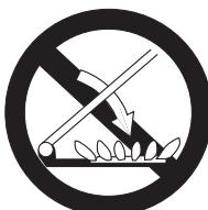
**BRĪDINĀJUMS!** Ja stikla pārsegs ir uzkarsis, tas var saplīst. Pirms pārsega aizvēršanas izslēdziet visus degdūus un elektriskās virsmas. \*Attiecas tikai uz modeļiem ar stikla pārsegu.
