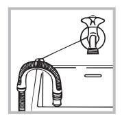
Autrement, accrocher le tuyau de vidange à un évier ou à une baignoire, dans ce cas, attacher la crosse (à acheter au service d'assistance) au robinet (voir figure). L'extrémité libre du tuyau d'évacuation ne doit pas être plongée dans
