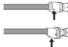
Pentru furtunuri cu oprire a alimentării cu apă: inspectați vizorul mic al supapei de siguranță (vedeți săgeata). Dacă se vede culoarea roșie, a fost declanșată funcția de oprire a alimentării cu apă, iar furtunul trebuie înlocuit cu unul nou. Pentru a desfileta acest furtun, apăsați butonul de deblocare (dacă intră în dotare) în timp ce desfiletați furtunul.
