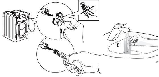
4. Introduceți la loc filtrul cu sită metalică. Conectați furtunul de alimentare la robinetul de apă și înapoi la mașina de spălat rufe. Nu utilizați un instrument pentru a conecta furtunul de alimentare. Deschideți robinetul de apă și asigurați-vă că toate conexiunile sunt etanșe.
