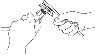
3. Acum desfiletați manual furtunul de alimentare din partea din spate a mașinii de spălat. Scoateți filtrul cu sită metalică din supapa localizată în partea din spate a mașinii de spălat folosind un clește și curățați-o cu atenție.
