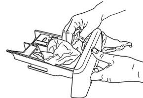
5. Remontați dozatorul de detergent și împingeți-l înapoi în compartimentul pentru detergent.
