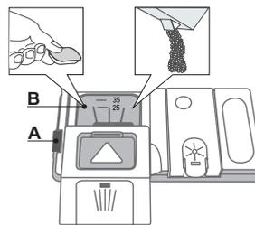
**Para abrir el dispensador de detergente utilice el mecanismo de apertura A. Introduzca el detergente solo en el dispensador B seco. Eche la cantidad de detergente para el prelavado directamente dentro de la cuba.**
