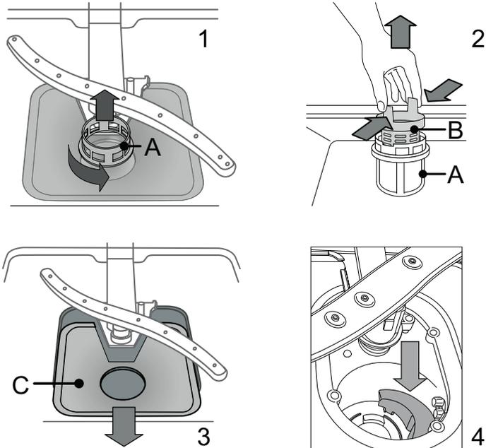
Una vez limpiados los filtros, recoloque el cuerpo de filtrado y encájelo correctamente en su sitio; esto es esencial para garantizar el funcionamiento eficiente del lavavajillas.
