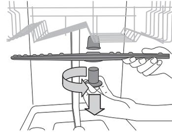
Para extraer el brazo aspersor superior, gire el anillo de cierre de plástico hacia la izquierda. El brazo rociador superior se tiene que recolocar de tal modo que el lado con más agujeros mire hacia arriba.
