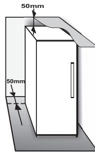
La distancia entre la parte trasera del aparato y la pared de detrás debe ser de como mínimo 50 mm.
