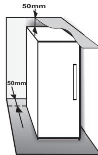
A distância entre a parte de trás do aparelho e a parede por trás deste deve ser no mínimo de 50 mm.
