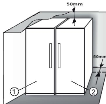
Συνιστάται να εγκαταστήσετε τις δύο συσκευές μαζί χρησιμοποιώντας το κιτ σύζευξης ③ (όπως φαίνεται στο σχήμα). Μπορείτε να το αγοράσετε μέσω του κέντρου εξυπηρέτησης πελατών.
