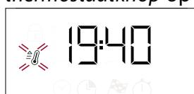
Let op: Tijdens de bereiding kan de functie gewijzigd worden door de keuzeknop te draaien of de temperatuur te regelen met de thermostaatknop. De functie zal niet starten als de thermostaatknop op **0/AUTO** staat. U kunt het einde van de bereiding (alleen wanneer een bereidingstijd ingesteld wordt) en een kookwekker selecteren.
