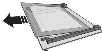
**3. Ponownie zamontować środkowy panel (oznaczony literą "R") przed przystąpieniem do montażu panelu wewnętrznego:** Aby właściwie umieścić szyby, należy upewnić się, że znak „R” jest widoczny w lewym rogu. W pierwszej kolejności należy umieścić dłuższą część szyby oznaczoną literą „R” w odpowiednich uchwytnach, a następnie obniżyć ją do właściwej pozycji. Powtórzyć tę procedurę dla obu szyb.
