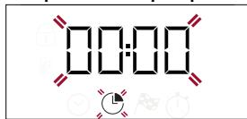
Utilice + o - para configurar el tiempo de cocción deseado y después pulse
