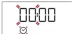
Utilice + o - para ajustar la hora y pulse para confirmar. Los dos dígitos de los minutos empezarán a parpadear.
