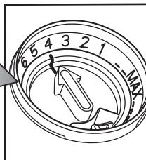
Množství leštidla je možné upravit podle použitého prostředku. Čím menší nastavení, tím méně leštidla program použije (nastavení z výroby: poloha 4). Stisknutím tlačítka otevřete víčko B. Mincí nebo podobným předmětem otočte šípkou do požadované polohy. Po nastavení množství leštidla víčko opět zavřete.
