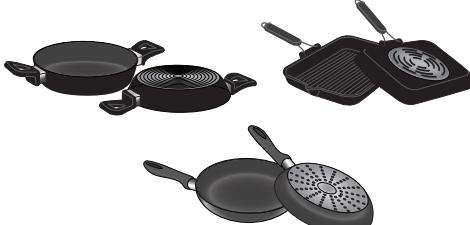
Da biste osigurali optimalnu učinkovitost, uvijek upotrebljavate lonece i posude ravnog dna koje ravnomjerno raspoređuje toplinu. Ako je dno neravno, to će utjecati na provodljivost snage i topline.
