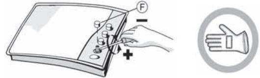
Quando terminar o ajuste, torne a selar usando cera ou um material equivalente.
