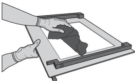
**3.** Réinstaller le panneau intermédiaire (marqué d'un "R1") avant de replacer le panneau intérieur : Pour placer correctement les parois de verre, assurez-vous que la marque « R » se trouve dans le coin gauche. En premier, insérez la longue partie de la vitre marquée d'un « R » dans les appuis des guides, abaissez-la ensuite en place. Répétez cette procédure pour les deux parois de verre.
