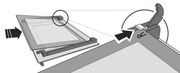
4. Зафиксируйте верхний край: Щелчок означает правильную установку. Перед установкой дверцы проверьте целостность уплотнения.
