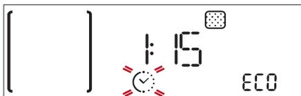
Rode o *botão de ajuste* para selecionar o ciclo pretendido e, em seguida, prima <sup>OK</sup>select para confirmar. O forno inicia o ciclo de limpeza automática e a porta do mesmo fecha-se automaticamente: é apresentada uma mensagem de aviso no visor, juntamente com uma contagem decrescente que indica o estado do ciclo em curso.
