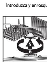
Introduzca y enrosque completamente el brazo inferior y el superior.
