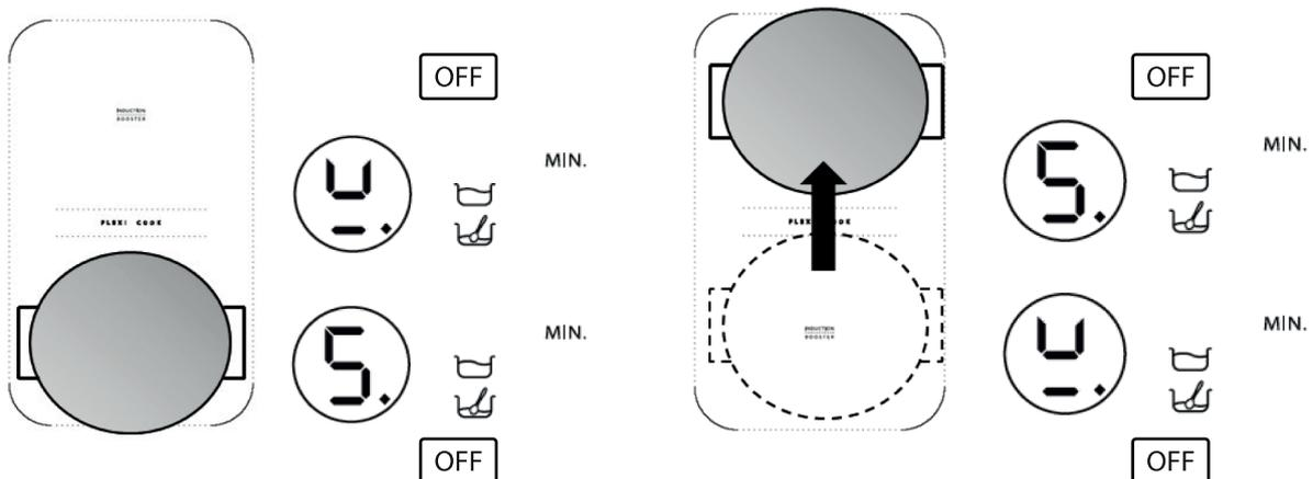
El área de cocción flexible también puede funcionar como dos zonas de cocción independientes utilizando el botón correspondiente de la zona individual. Coloque la olla en el centro de la zona individual y ajuste el nivel de potencia con la barra táctil.
