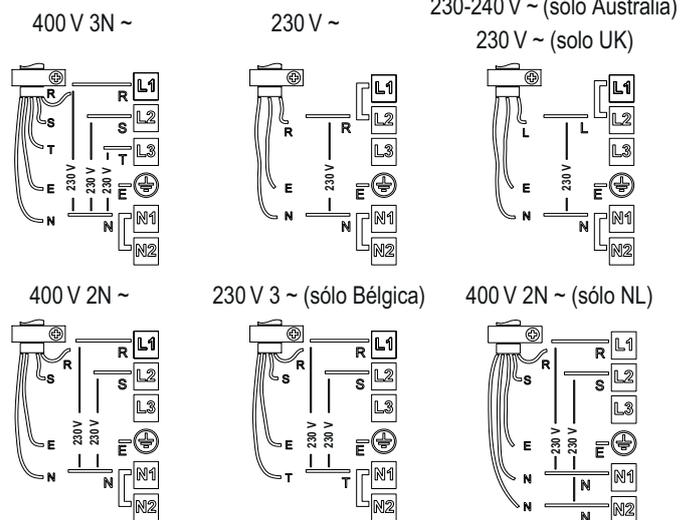
Conecte el conductor de toma de tierra amarillo/verde al terminal marcado con el símbolo
