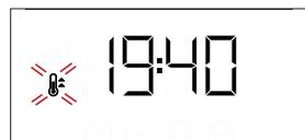
Σημείωση: Κατά τη διάρκεια ψησίματος μπορείτε να αλλάξετε λειτουργία γυρίζοντας το κουμπί επιλογής ή να ρυθμίσετε τη θερμοκρασία γυρίζοντας τον επιλογέα θερμοστάτη. Η λειτουργία δεν ξεκινάει αν το κουμπί θερμοστάτη είναι ενεργό. Μπορείτε να ρυθμίσετε το χρόνο ψησίματος, το χρόνο τέλους ψησίματος (μόνο εάν ρυθμίσετε το χρόνο ψησίματος) και το χρονοδιακόπτη.
