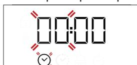
Utilizați + sau - pentru a seta ora și apăsați pe pentru a confirma. Cele două cifre aferente minutelor vor începe să clipească. Utilizați + sau - pentru a seta minutele și apăsați pentru a
