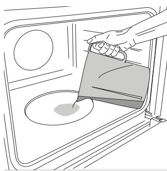
Tek kada je pećnica hladna, napunite udubljenje u pećnici količinom vode navedenom u odgovarajućoj tablici pečenja. Namirnice stavite u pećnicu. Postavite i uključite funkciju **STEAM**: Na kraju pažljivo otvorite vrata i pustite da para polako izade.
