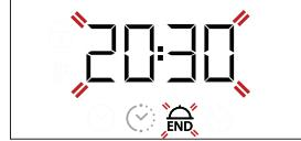
Koristite + ili - da podešite vreme kada želite da se pečenje završi i pritisnite za potvrdu. Pokrenite funkciju tako što ćete okrenuti dugme termostata na željenu temperaturu: funkcija će biti pauzirana i pokrenuće se automatski nakon izračunatog vremenskog perioda koji je potreban da bi hrana bila gotova u vreme koje ste podešili.
