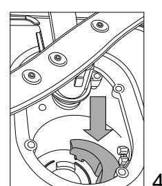
μετά τον καθαρισμό των φίλτρων, επαναποθετήστε το φίλτρο και στερεώστε το καλά στη θέση του. Αυτό είναι σημαντικό για να διατηρείται η αποτελεσματική λειτουργία του πλυντηρίου πιάτων.
