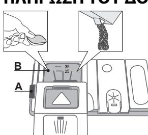
**Για να ανοίξετε το δοχείο απορρυπαντικού χρησιμοποιήστε τη διάταξη ανοίγματος **A**.**
