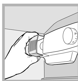
Accedere alla lampada togliendo la protezione come indicato in figura. Sostituirla con una analoga di potenza a quella indicata sulla protezione (15 W o 25 W).
