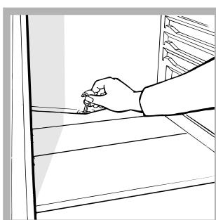
Le réfrigérateur est muni d'un système de dégivrage automatique : l'eau est acheminée vers la paroi arrière par un trou d'évacuation (voir figure) où la chaleur produite par le compresseur la fait évaporer. Il vous suffit de nettoyer périodiquement le trou d'évacuation pour permettre à l'eau de s'écouler normalement.
