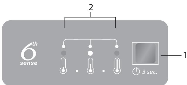
1. Tlačidlo ZAP./POHOT. REŽIM a tlačidlo Teplota
