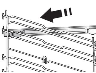
Ancorare alla griglia laterale la clip superiore della guida e farla scivolare fino a fine corsa. Abbassare in posizione l'altra clip.
