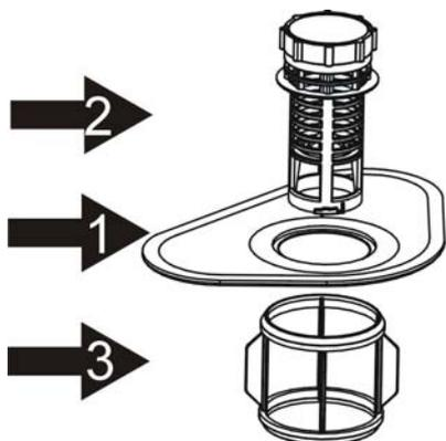
El sistema de filtro consta de un filtro grueso, un filtro plano (filtro principal) y un microfiltro (filtro fino).
