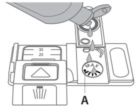
1. Abra el dispensador B pulsando y subiendo la lengüeta de la cubierta.
