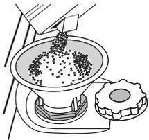
1. Retire la bandeja inferior y desenrosque el tapón del depósito (hacia la izquierda).
