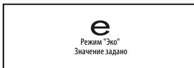
**При включенном режиме ECO** дисплей автоматически гаснет через некоторое время в целях экономии электроэнергии. При нажатии любой кнопки или открывании дверцы дисплей вновь загорается.
