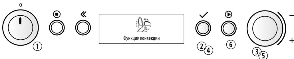
1. Вращая многофункциональную ручку, выберите режим “Функции конвекции”.
