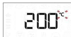
Când pictograma °C/F clipește pe afișaj, rotiți butonul pentru modificarea valorii, apoi apăsați pentru confirmare și continuați să modificați următoarele setări (dacă este posibil). De asemenea, puteți seta nivelul de grill (3 = ridicat, 2 = mediu, 1 = redus) în același timp.
