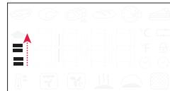
Po završetku te faze oglasit će se zvučni signal i na zaslonu će se prikazati da je pećica dosegna postavljenu temperaturu.
