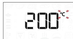
Kada ikona °C/F treperi na zaslonu okrenite gumb za promjenu vrijednosti i pritisnite za potvrdu te nastavite s promjenom sljedećih postavki (ako je moguće). Istovremeno možete postaviti i razinu roštilja (3 = visoka, 2 =
