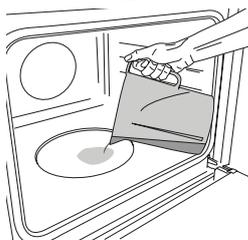
A forno freddo, riempire la cavità sul fondo del forno con la quantità d'acqua potabile indicata nella tabella di cottura. Introdurre la pietanza nel forno.
