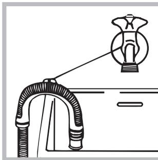
In alternativa, appoggiare il tubo di scarico al bordo di un lavandino o di una vasca, legando la guida (acquistabile presso il servizio assistenza) al rubinetto (vedi figura). L'estremità libera del tubo
