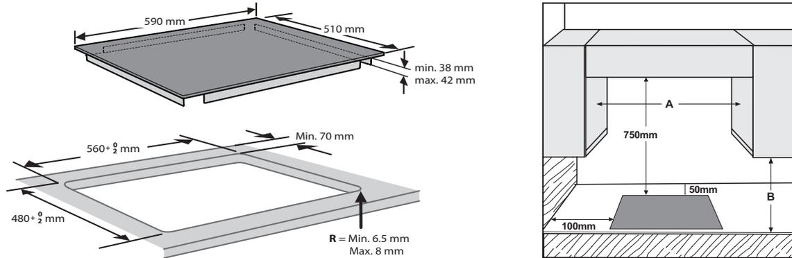
**NOTA:** se a distância "A" entre a parede dos armários for entre 600 mm e 730 mm, a altura "B" terá de ser, no mínimo, de 530 mm. Se a distância "A" entre a parede dos armários for maior do que a largura da placa, a altura "B" terá de ser, no mínimo, de 400 mm. Em caso de instalação de um exaustor por cima da placa, consulte as instruções do exaustor para uma distância correcta.
