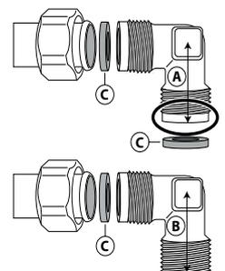
**IMPORTANTE:** Antes da ligação, remova a tampa para o transporte do furo de engate do tubo do gás do plano de cozedura.
