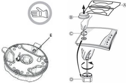
Antes de instalar a placa, não se esqueça de afixar a placa de calibração do gás fornecida com os injetores, de forma que esta cubra a informação anterior relativa à calibração de gás.
