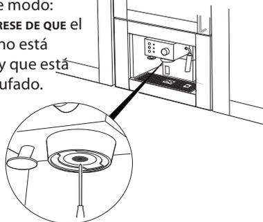
**2. CON UN DESTORNILLADOR,** suelte el tornillo que fija el filtro del conducto de salida de la caldera.
