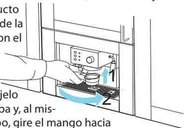
1. **ENCIENDA EL APARATO** pulsando el botón de encendido/apagado y coloque el portafiltros en el aparato sin añadir el café.
