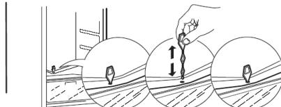
pomoću priloženog alata redovito čistite unutarnjost drenažnog otvora na stražnjoj strani hladnjaka, u blizini ladiće za voće i povrće.
