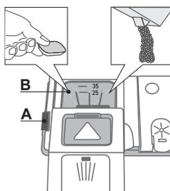
**Para abrir o distribuidor de detergente, utilize o dispositivo de abertura A. Coloque o detergente apenas no distribuidor seco B. Coloque a quantidade de detergente para pré-lavagem diretamente na cuba.**
