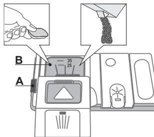
**Para abrir el dispensador de detergente utilice el mecanismo de apertura A.**
