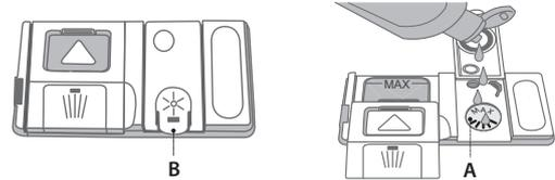
1. Abra el dispensador **B** pulsando y levantando la lengüeta de la tapa.
