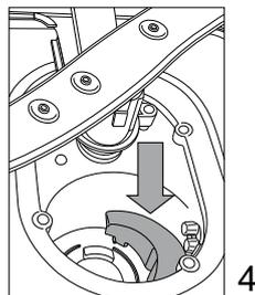
Una vez limpiados los filtros, recolóque el cuerpo de filtrado y encájelo correctamente en su sitio; esto es esencial para garantizar el funcionamiento eficiente del lavavajillas.
