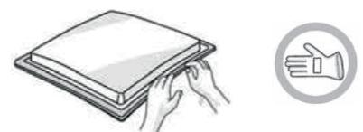
Coloque la placa en la abertura realizada en la encimera respetando las dimensiones indicadas en las instrucciones.
