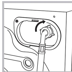
2. A vízbevezető cső csatlakoztatásához csavarozza a csövet a mosógép hátoldalán jobbra fent található vízbemeneti csonkra (lásd ábra)!
