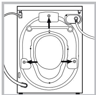
3. Odkręcić 3 śruby zabezpieczające urządzenie na czas transportu oraz zdjąć gumowy element z podkładką, znajdujący się w tylnej części pralki (patrz rysunek).
