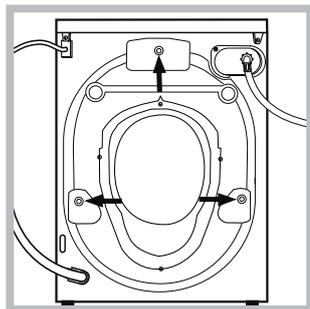
3. Csavarozza ki a gép hátsó részén található, a szállításához szükséges 3 védőcsavart, és távolítsa el a gumibakot (lásd ábra).
