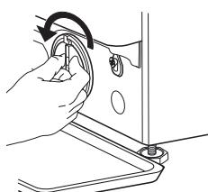
4. Снимите фильтр: положите под водяной фильтр хлопчатобумажную ткань, которая может впитать небольшое количество воды. Затем снимите водяной фильтр, повернув его против часовой стрелки.
