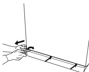
2. Емкость для слитой воды: установите низкую широкую емкость под водяной фильтр для сбора оставшейся воды.
