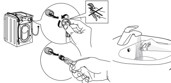
4. Верните сетчатый фильтр на свое место. Снова подсоедините заливной шланг к крану подачи воды и к стиральной машине. Для присоединения заливного шланга не используйте инструменты. Откройте кран подачи воды и убедитесь в герметичности всех соединений.
