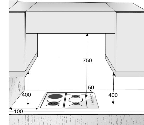
**ΣΗΜΕΙΩΣΗ:** Σε περίπτωση εγκατάστασης ενός απορροφητήρα πάνω από την εστία, ανατρέξτε στις οδηγίες του απορροφητήρα για τη σωστή απόσταση.
