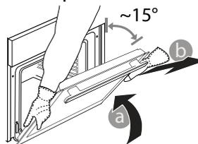
**Per rimontare la porta**, avvicinarla al forno allineando i ganci delle cerniere alle proprie sedi e ancorare la parte superiore agli alloggiamenti.
