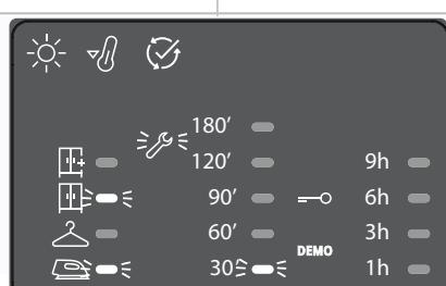
Das Symbol des Schraubenschlüssels weist auf eine Störung hin. Die nachstehend beschriebenen Abläufe ausführen.
