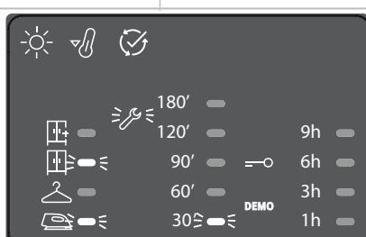
Het symbool van de moersleutel signaleert een storing. Voer de beschreven handelingen uit. Schakel de droogautomaat uit en trek de stekker uit het stopcontact. Open onmiddellijk de deur en haal het wasgoed eruit om het apparaat af te laten koelen. Wacht ongeveer een uur. Steek de stekker weer in het stopcontact, vul de trommel en start de droogcyclus opnieuw.
