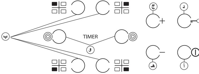
عند التركيب لأول مرة، تجري لوحة التحكم اختباراً وظيفياً لمدة ثانية واحدة تقريباً، وبعد هذا الاختبار تنتقل تلقائياً إلى وظيفة "قفل المفاتيح". لإلغاء تنشيط الوظيفة، اضغط مع الاستمرار فوق الزر "د"، وستصدر إشارة تحذير وسينطفئ مؤشر LED ذو الصلة. **ملاحظة:** إذا تمت إعادة التشغيل، ففكر الإجراء الموضح أعلاه.
