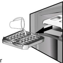
Placera Ice Mate i frysfacket eller för in isbitslådan i Ice Mate. Se till att inte spilla vatten.
