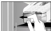
**AVVERTENZA:** riempire solo con acqua potabile (livello massimo = 2/3 della capacità totale).
